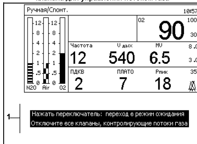
Рис. 114. Сообщение о подтверждении режима ожидания и окно сообщения выключения клапана для управления потоком газа
