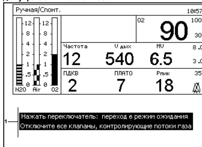
Рис. 117. Сообщение о подтверждении режима ожидания и окно сообщения о выключении клапана для управления потоком газа
