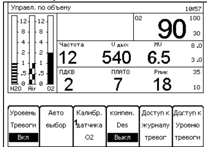
Рис. 99. Экран инструкций по калибровке датчика O 2
