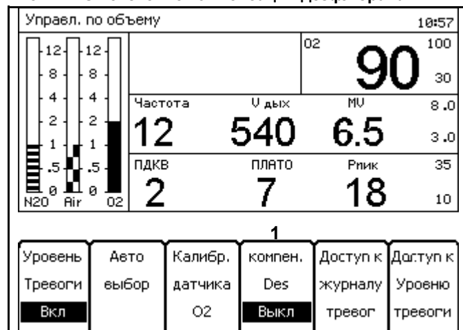
Рис. 112. Отключение компенсации дезфлюрана
